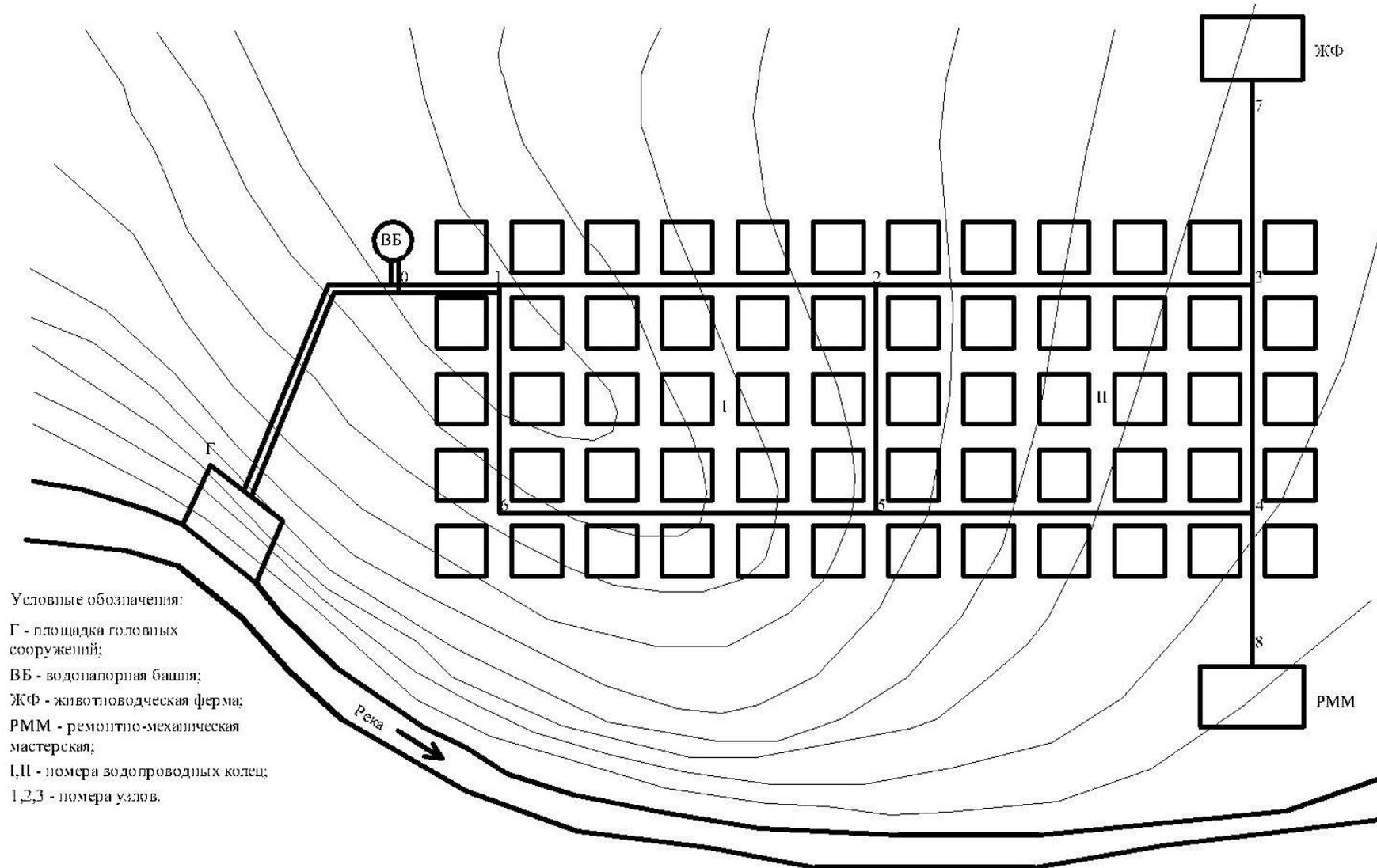
Гидравлический расчет водопроводной сети заключается в определении расчетных расходов по участкам, диаметров трубопровода, свободных напоров.
