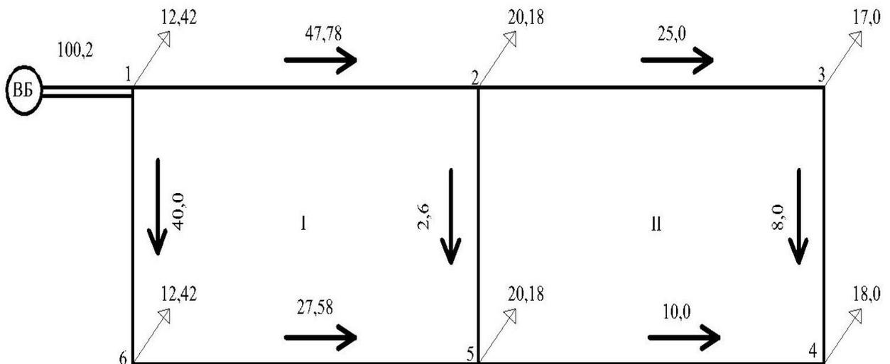
Расходы, проходящие по трубам, называются расчетными и находятся по 1-му закону Кирхгофа: *сумма расходов, приходящих в узел должна быть равна сумме расходов из узла выходящих.*
