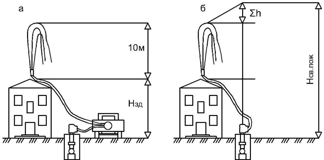
Рисунок 5 - Схемы тушения пожара из водопровода:
